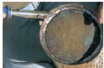
**5. Positionner le fond dans le seau et le souder tout autour, en commençant par faire quelques points de soudure sur le pourtour.**
